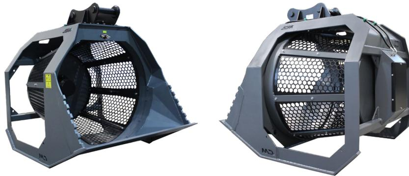
Caçamba peneira com cesto de grelhas aparafusadas intercambiáveis, concebido para a seleção de material como fundo de rio, solos pedregosos, inertes provenientes de demolições ou similares.
